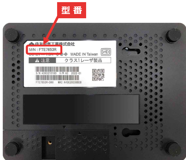
回線終端装置 (住友電工製FTE7653R-DAXの場合)
